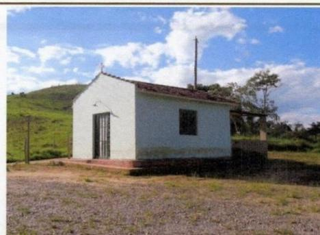
A arquitetura religiosa de forma simples, nave única, frontão em tímpano triangular, telhado de duas águas com telha capa e canal, estrutura de madeira, alvenaria de tijolos.
