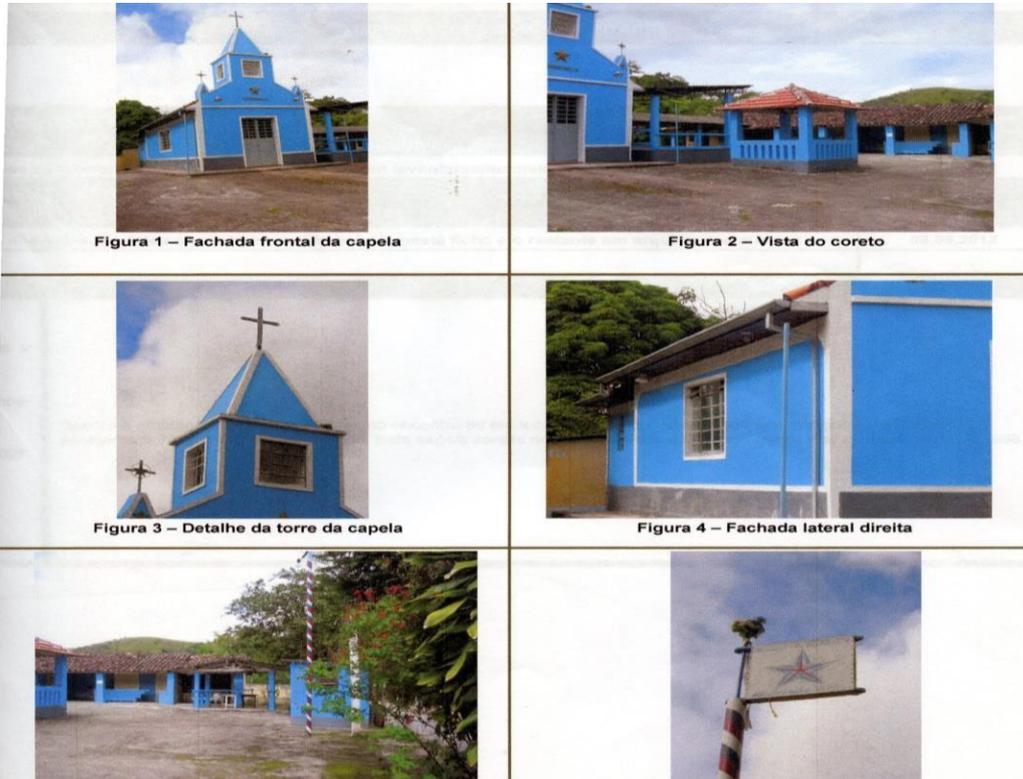
A arquitetura religiosa de forma simples, nave única, altar separado, frontão com torre central onde tem um sino, telhado de duas águas com telha capa e canal, estrutura de madeira e alvenaria de tijolos.
