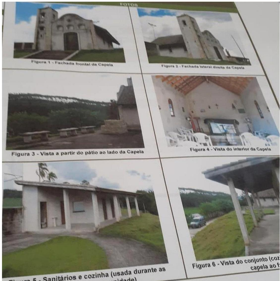
A arquitetura religiosa é simples, com planos regulares, sem volumetria evidente, apresentando nave única e sem cúpula. Possui telhado de duas águas e uma torre sineira na lateral esquerda. A edificação é recente, não tendo mais do que 10 anos, e foi construída em substituição à antiga capela. Apesar de estar inacabada, apresenta-se em bom estado de conservação.
